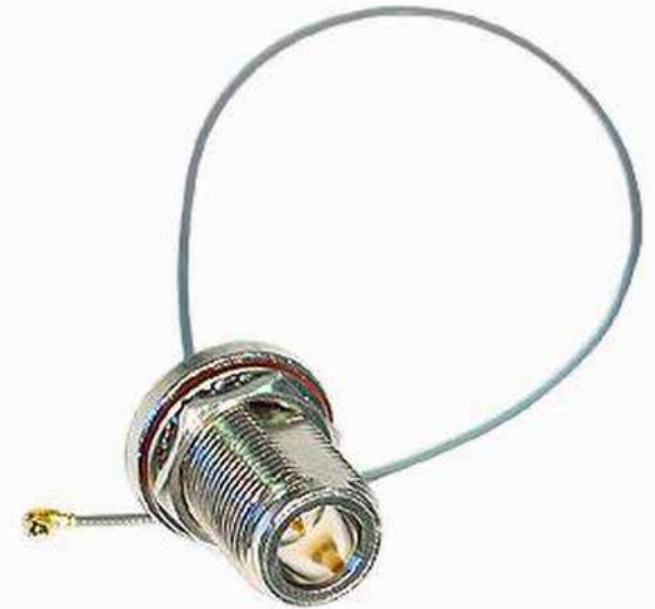
Nfemale-ufl για σασί καλής ποιότητας (πιο χονδρό καλώδιο-μεσαίο μέγεθος)
